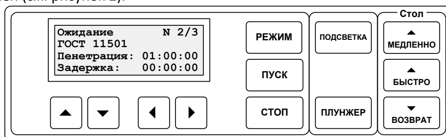
Рисунок 2 – Лицевая панель пенетрометра
