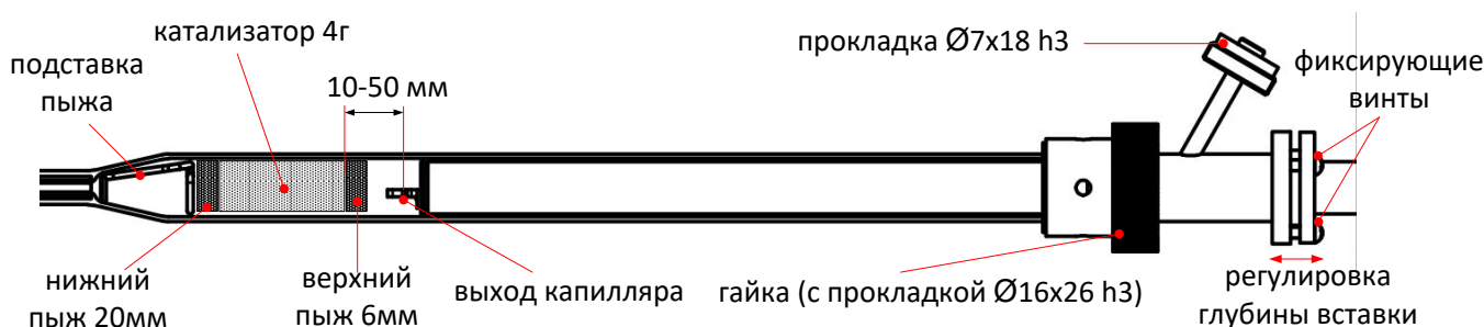
Рисунок 13 – Реактор в сборе
