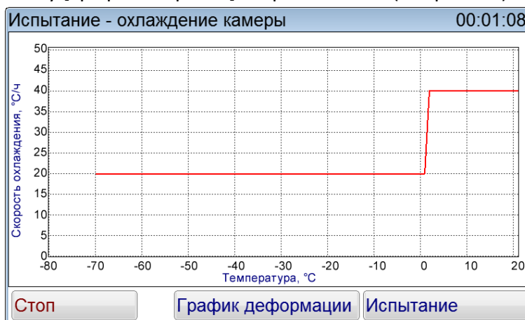
Рисунок 15 – Испытание - охлаждение камеры (график скорости)
