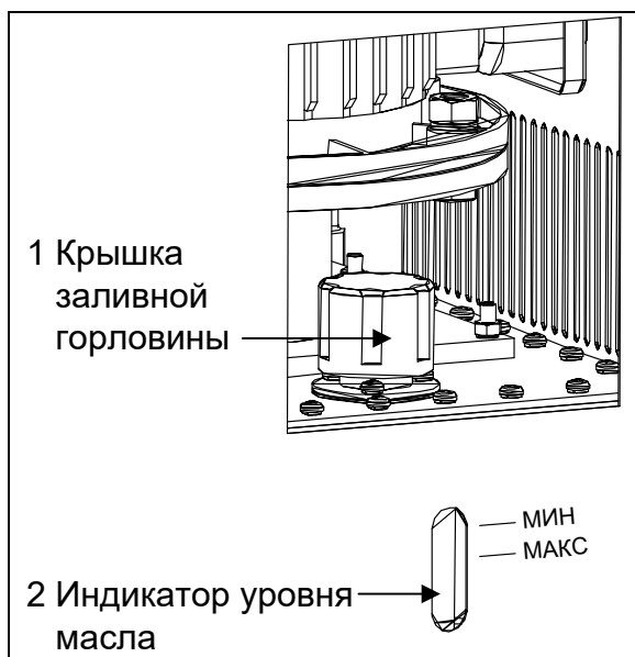
Рисунок 28. Расположение заливной горловины и индикатора уровня масла
