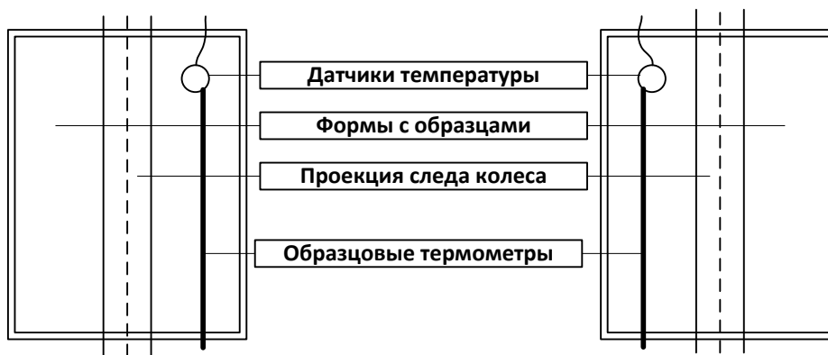
Рисунок 5 - Расположение датчиков на поверхности образца. Вид сверху.
