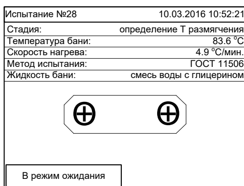
Рисунок 3 - Окно процесса испытания (нагрев с постоянной скоростью)
